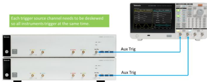
수동 지연 보정 및 Aux 트리거 입력을 사용하여 200 ps 내에서 여러 계측기 채널 동기화
